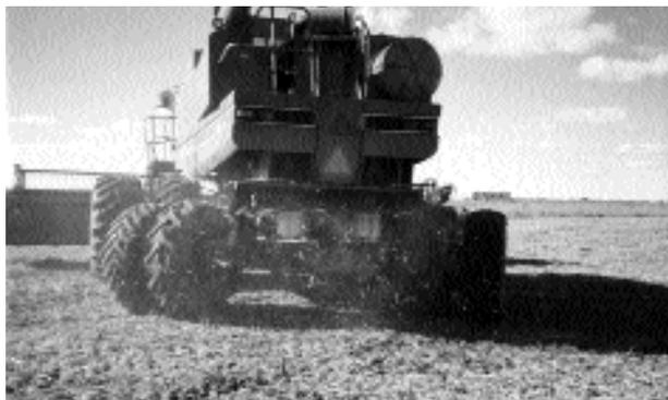
Figura 21: Cosechadora equipada con neumáticos duales adelante y atrás
