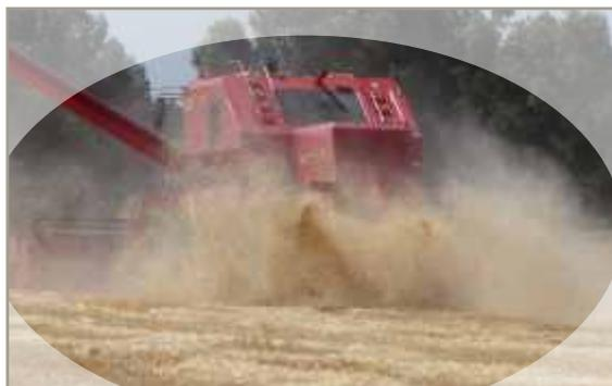
Figura 29: Cosechadora trabajando a velocidad constante sin regulador de flujo.
