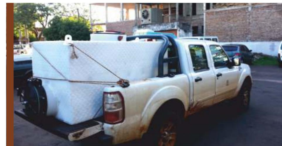
Las cajas de transporte de peces a granel deben poseer aislamiento térmico, permitiendo el transporte de peces bajo cualquier tiempo, sin que exista una gran elevación o reducción de la temperatura del agua en el interior de las cajas.
