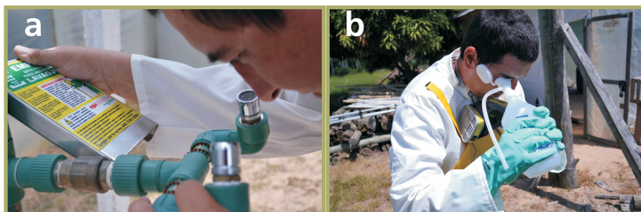
Figura 13. Lava ojos: a) Fijo y b) Portátil). Fotos: EEA INTA Bella Vista.
