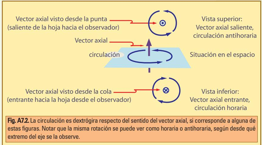
**Fig. A7.2.** La circulación es dextrógira respecto del sentido del vector axial, si corresponde a alguna de estas figuras. Notar que la misma rotación se puede ver como horaria o antihoraria, según desde qué extremo del eje se la observe.
