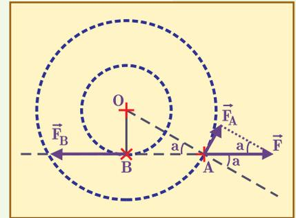
**Fig. 7.6.** Dada  $\vec{F}_B$  aplicada tangencialmente en B, para encontrar la fuerza que pueda equilibrar su poder de rotación aplicada tangencialmente en una circunferencia de mayor radio, debe prolongarse la tangente en B hasta cortar a la circunferencia mayor. En ese punto, denominado A, se proyecta tangencialmente  $-\vec{F}_B$  y se obtiene  $\vec{F}_A$ .
