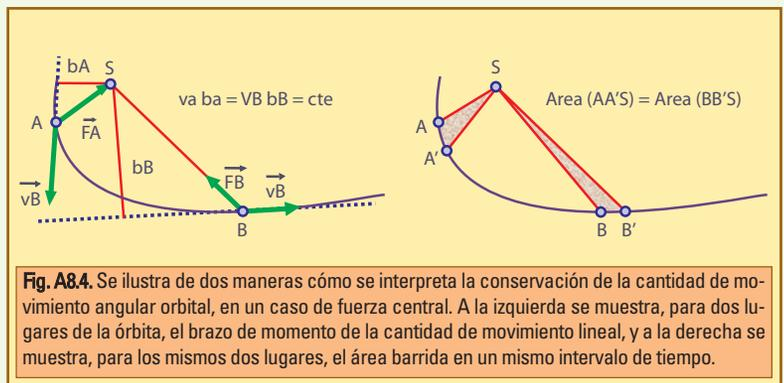
Fig. A8.4. Se ilustra de dos maneras cómo se interpreta la conservación de la cantidad de movimiento angular orbital, en un caso de fuerza central. A la izquierda se muestra, para dos lugares de la órbita, el brazo de momento de la cantidad de movimiento lineal, y a la derecha se muestra, para los mismos dos lugares, el área barrida en un mismo intervalo de tiempo.
