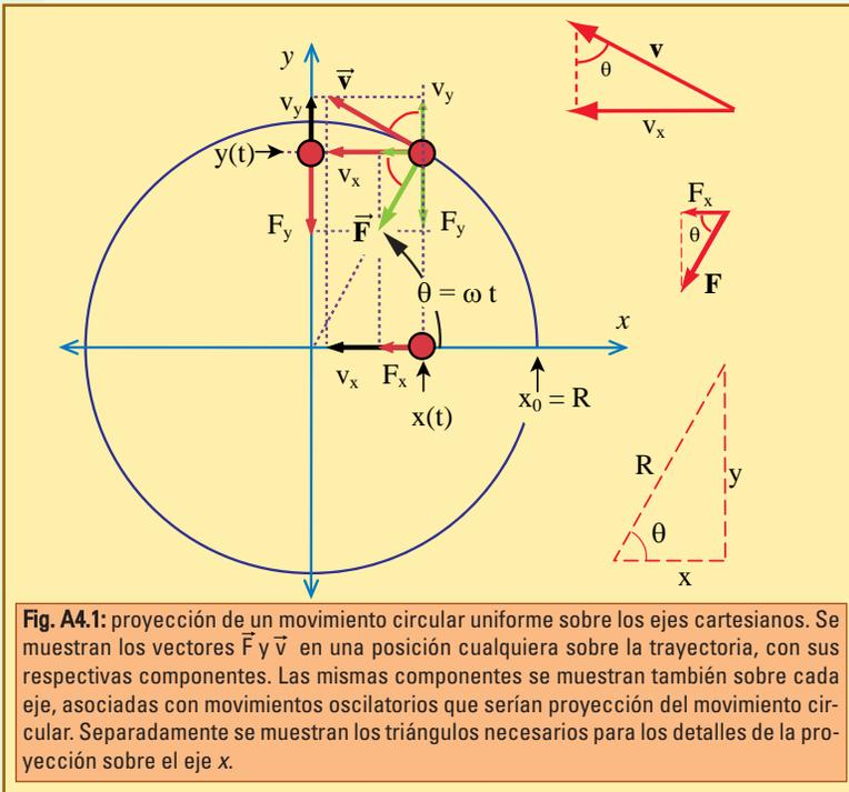
**Fig. A4.1:** proyección de un movimiento circular uniforme sobre los ejes cartesianos. Se muestran los vectores  $\vec{F}$  y  $\vec{v}$  en una posición cualquiera sobre la trayectoria, con sus respectivas componentes. Las mismas componentes se muestran también sobre cada eje, asociadas con movimientos oscilatorios que serían proyección del movimiento circular. Separadamente se muestran los triángulos necesarios para los detalles de la proyección sobre el eje x.
