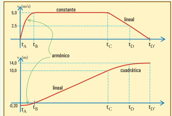
c) Entre A y B, el movimiento es un cuarto de oscilación en el extremo de un resorte. Por lo tanto dura  $T/4 = \pi (m/k)^{1/2} / 2 \cong 0,0628 \text{ s}$
