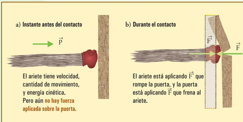
**Fig. 6.3.** El ariete es detenido por la fuerza  $\vec{F}$  que le aplica la puerta. Pero ello no puede ocurrir sin que el ariete deforme (y tal vez rompa) al obstáculo aplicándole la fuerza  $\vec{F}$ , y avanzando la distancia necesaria para hacer un trabajo igual a la energía cinética que tenía antes del contacto.
