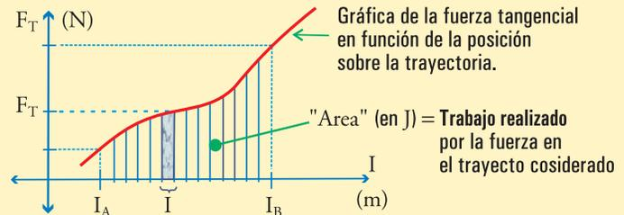
**Fig. 6.4.** Si la trayectoria se divide en pequeños segmentos de longitud  $\delta l$ , el trabajo en cada uno de ellos,  $F_T \delta l$ , es el área del rectángulo de ancho  $\delta l$  y altura  $F_T$ . El trabajo total hecho en el intervalo es la suma de todas las contribuciones, o sea, toda el área sombreada.
