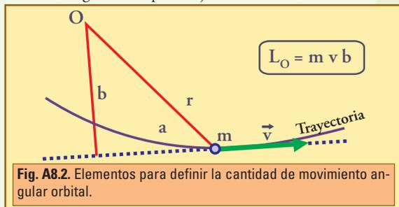
Fig. A8.2. Elementos para definir la cantidad de movimiento angular orbital.
