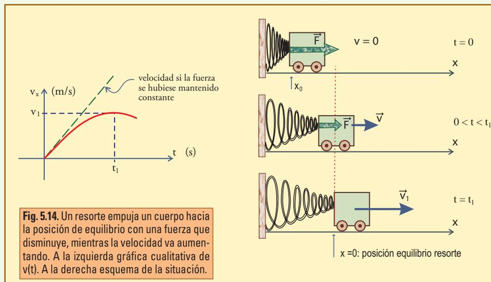
**Fig. 5.14.** Un resorte empuja un cuerpo hacia la posición de equilibrio con una fuerza que disminuye, mientras la velocidad va aumentando. A la izquierda gráfica cualitativa de  $v(t)$ . A la derecha esquema de la situación.
