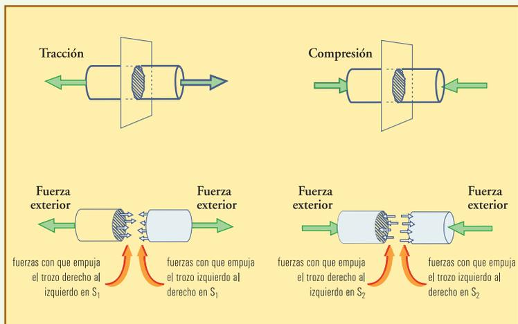
**Fig. A2.1.** Tensiones de tracción actuando a través de secciones como  $S_1$ , y de compresión a través de  $S_2$ . Para cada cuerpo se lo puede considerar dividido en partes en la sección indicada, y abajo se muestra el diagrama de cuerpo libre de cada parte de cada cuerpo. En cada sección se han dibujado pequeños vectores representativos de las fuerzas distribuidas, y esto es válido para cada una de las infinitas secciones transversales imaginables.
