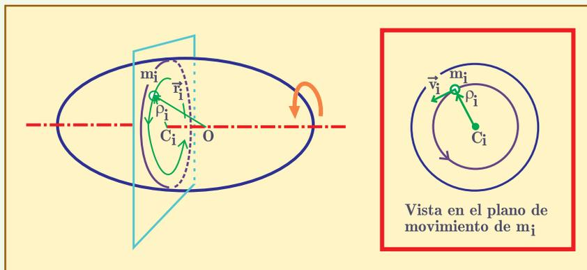
**Fig. 7.3.** Cada partícula  $i$  describe, en un plano perpendicular al eje, una circunferencia cuyo centro  $C_i$  es la intersección de dicho plano con el eje. El radio de esta circunferencia es  $\rho_i$ , que resulta ser la proyección del vector posición  $\vec{r}_i$  sobre el plano del movimiento, y que indica también la distancia desde la partícula hasta el eje.
