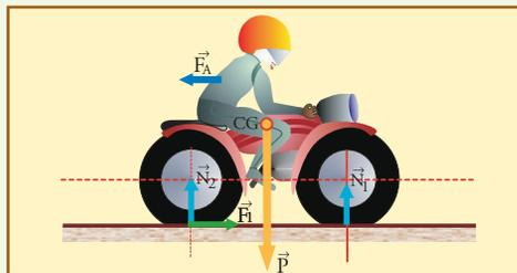
• El peso,  $\vec{P}$ , de módulo igual a  $9,8 \times 180 = 1.764 \text{ N}$ , aplicado en el CG (es la resultante de la acción del campo gravitatorio distribuida por toda la masa del sistema),
