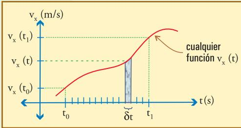
**Fig. 5.7.** Si para cualquier intervalo de base  $\delta t$ , multiplicamos la base por la altura  $v_x(t)$  en algún punto intermedio, obtenemos el área sombreada, que a la vez debe ser la distancia  $\delta x$  recorrida en ese lapso. Si  $\delta t$  es suficientemente pequeño se puede considerar un instante, y la altura del rectángulito es la velocidad en ese instante.
