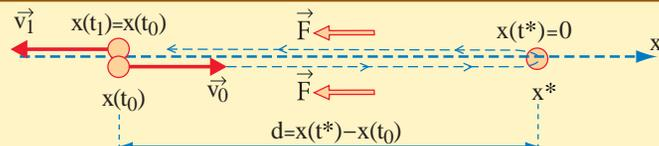
**Fig. 5.12.** Móvil que avanza una distancia  $d$  contra la fuerza. Ésta lo detiene y luego lo acelera, y al cabo de la distancia  $d$  el móvil tiene la misma velocidad inicial, con signo opuesto. Pero  $\Delta x$  ya no indica la distancia recorrida.
