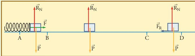
b)  $v_B$  se calcula a partir de la energía cinética en B, que debe ser igual a la potencial del resorte en A (para llegar a esto se parte de la conservación entre A y B:  $Ec_A + Ep_A = Ec_B + Ep_B$ , con  $Ec_A = 0$ , y  $Ep_B = 0$ ). De manera que  $Ep_A = 10.000 \text{ (N/m)} \times (0,2\text{m})^2 / 2$
