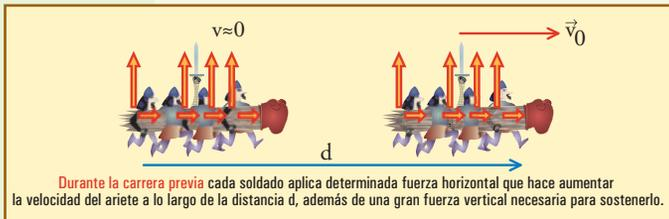
El ariete adquiere entonces una energía cinética  $E_{c0} = \frac{1}{2} m v_0^2 = W$ , y sólo podrá detenerse si una cantidad de trabajo  $W'$  igual es efectuado por una fuerza externa que le quite esa cantidad de energía. Es decir:
