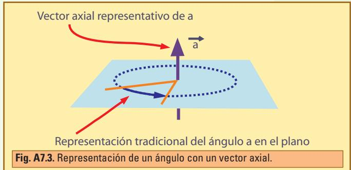
**Fig. A7.3.** Representación de un ángulo con un vector axial.
