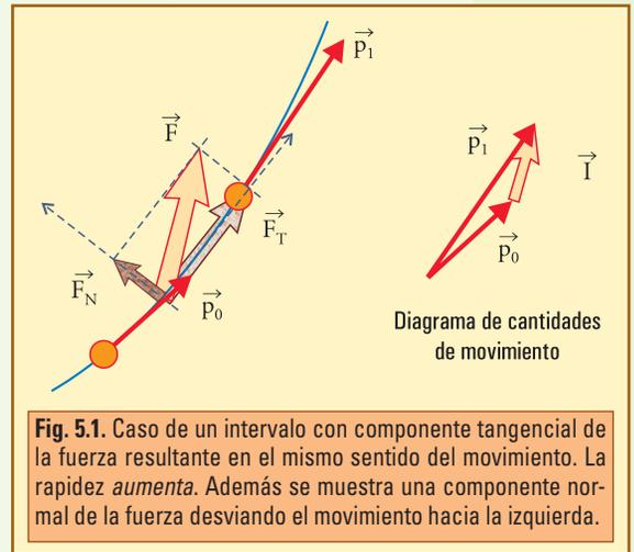
**Fig. 5.1.** Caso de un intervalo con componente tangencial de la fuerza resultante en el mismo sentido del movimiento. La rapidez *aumenta*. Además se muestra una componente normal de la fuerza desviando el movimiento hacia la izquierda.
