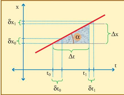
**Fig. 5.6.** Función  $x(t)$  lineal. Los triángulos sombreados, al ser todos semejantes, sirven para ver que los cocientes  $\delta x / \delta t$  tienen igual valor en los distintos instantes:  $\delta x_1 / \delta t_1 = \delta x_0 / \delta t_0 = \Delta x / \Delta t$
