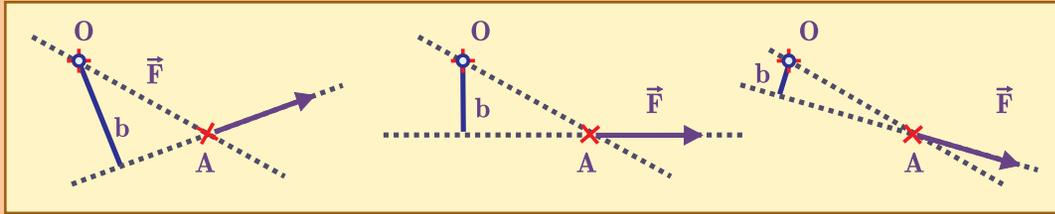
**Fig. 7.8:** Cuando la fuerza se aplica oblicuamente, el brazo de palanca debe buscarse como la distancia entre  $O$  y la recta de acción de la fuerza, tomada perpendicularmente a la recta (la distancia de un punto a una recta sólo tiene sentido entendida de esta manera).
