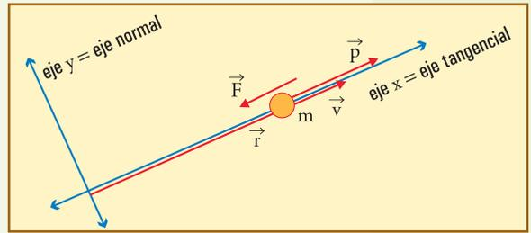
**Fig. 5.5.** Elección típica de ejes para un movimiento rectilíneo. El vector fuerza se dibujó arbitrariamente de manera de representar una fuerza que está frenando al móvil y debe estar claro que es la fuerza **resultante de todas las acciones exteriores en ese instante**.
