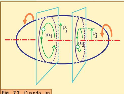
**Fig. 7.2.** Cuando un cuerpo describe una rotación pura los puntos del eje permanecen inmóviles, mientras los otros describen circunferencias en planos perpendiculares al eje. Como se ilustra, el cuerpo en rotación no necesita tener simetría ni forma determinada.
