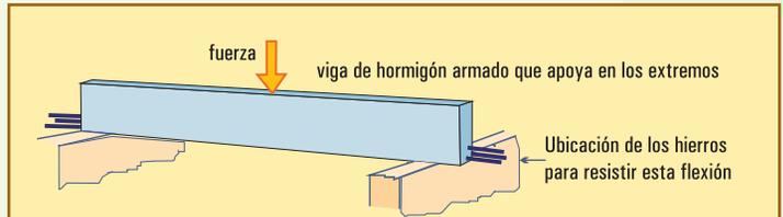
Fig. A2.6. Ubicación de las varillas de acero en una viga de hormigón armado
