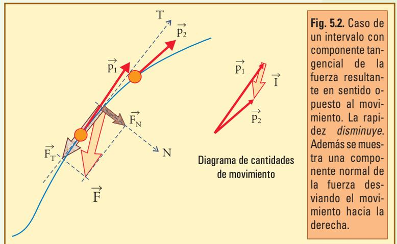
**Fig. 5.2.** Caso de un intervalo con componente tangencial de la fuerza resultante en sentido opuesto al movimiento. La rapidez *disminuye*. Además se muestra una componente normal de la fuerza desviando el movimiento hacia la derecha.
