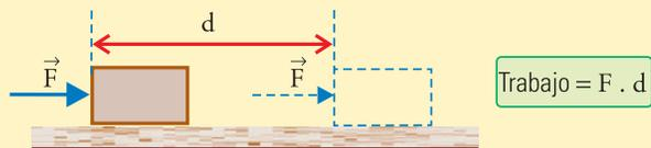
Fig. 6.1. Esquema de una fuerza que desplaza un cuerpo y realiza un trabajo.
