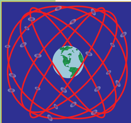
Figura 10.9. Esquema de las órbitas de los satélites que conforman el sistema GPS.
