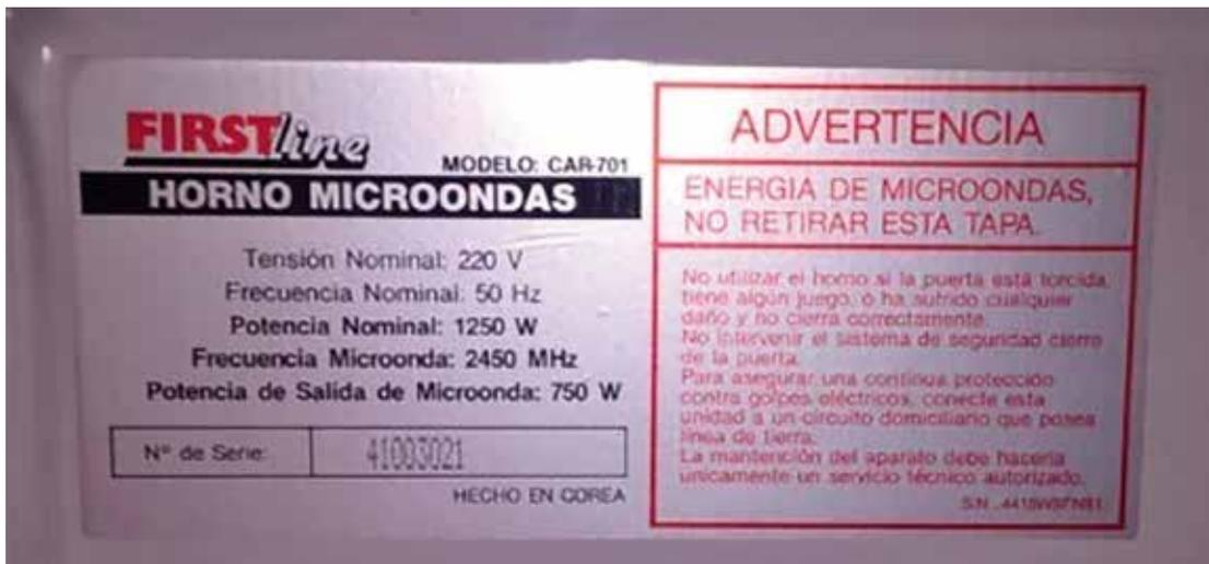
Figura 3. Chapa de la parte trasera de un horno, donde se ven valores de frecuencia
