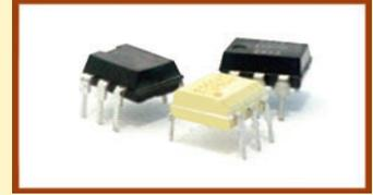
¿Qué utilidad tiene ese componente? ¿Por qué enviar una señal eléctrica a un led, hacer que la luz que emite excite un fototransistor para que conduzca, y obtener de éste, en suma, una nueva señal eléctrica? ¿No podríamos utilizar, en ese caso, directamente, la señal eléctrica de entrada, amplificada si fuere necesario?
