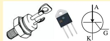
Un diodo controlado se comporta de manera semejante a la de un diodo común, pero sólo conduce entre sus electrodos principales, el ánodo  $A$  y el cátodo  $K$ , cuando recibe una señal por un electrodo de control, la compuerta  $G$ .
