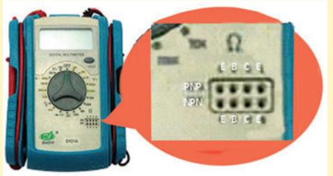
● **Multímetro con zócalo de prueba de transistores, con contactos repetidos, útiles para no tener que doblar las patas, según el orden en que estén dispuestos el emisor, la base y el colector.**
