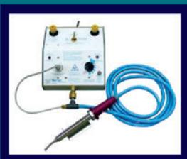
la soldadura se suele hacer con una ola que se genera en una cubeta de estaño fundido, sobre la que se coloca la placa del circuito impreso con las patas de los componentes ya puestas en los agujeros. Sin embargo, los prototipos, o circuitos especiales de bajo volumen de producción, se suelen armar con esta útil herramienta. Al lado, un soldador de nitrógeno caliente (mejor que el aire, porque no oxida) para soldar componentes muy pequeños, llamados de montaje de superficie.
