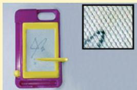
● **Pizarra magnética.** El imán levanta partículas oscuras sumergidas en un líquido blanco y espeso. Para borrar, se desliza un imán por atrás. El juguete es una variante de uno más antiguo, la *pizarra mágica*, en la que un papel manteca se adhería a un fondo oscuro pegajoso, del que se despegaba, para borrar, con una tirilla deslizante.
