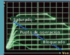
● Curvas características de un transistor, trazadas, automáticamente, en la pantalla de un osciloscopio. Arriba, en conducción plena, o saturación; abajo, sin conducción, o corte; en el centro, el punto de operación normal, en el cual el transistor es sensible a la señal de entrada.
