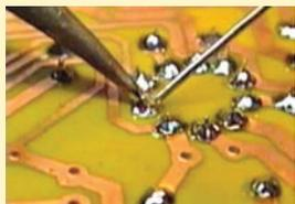
● **La soldadura con aleación de plomo y estaño, sigue siendo la principal forma de contacto fijo en los circuitos electrónicos. Se la desalienta, sin embargo, por la toxicidad del plomo.**
