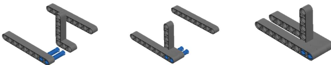
Unión fija y transversal de vigas usando conectores triples.
