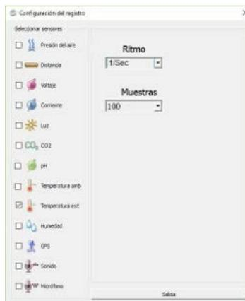
5. Una vez realizada la configuración del sensor, es posible iniciar las mediciones oprimiendo el botón **Correr**.
