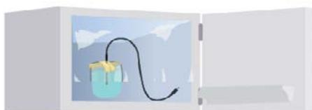
4. Después de 24 horas, retirar el vaso con el sensor del congelador.
