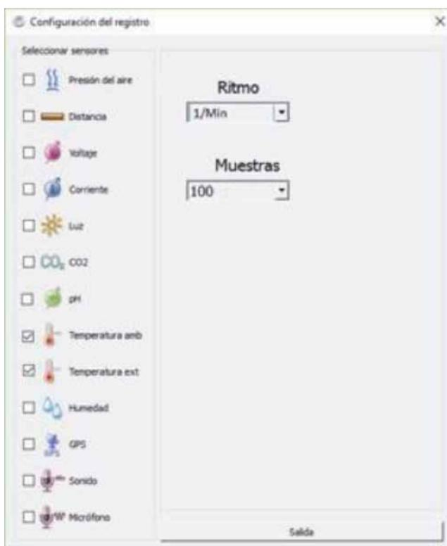
5. Seleccionar los sensores de temperatura ambiente y de temperatura externa.
