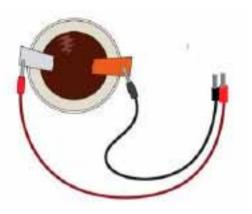
Una vez finalizado el armado, midan el voltaje de la batería empleando el Labdisc y los cables banana rojo y negro. Luego completen en la tabla el valor del voltaje obtenido, en el espacio correspondiente.
