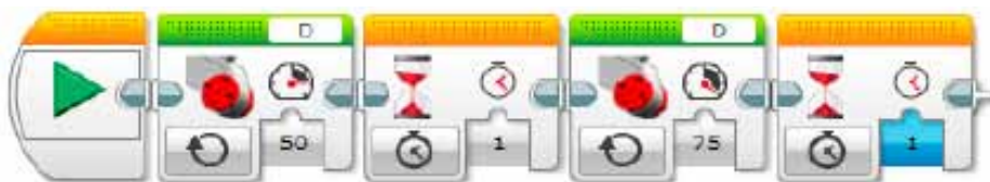
Programa 2. Dos bloques de encendido de motor y dos esperas de tiempo
