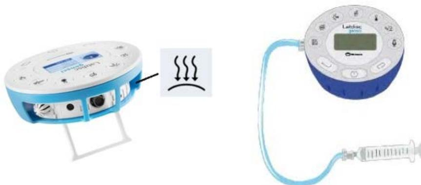
4. Llenar con aire la jeringa, hasta su máxima capacidad indicada en la escala y conectarla al otro extremo de la manguera de presión, que ya se encuentra enroscada al dispositivo.
