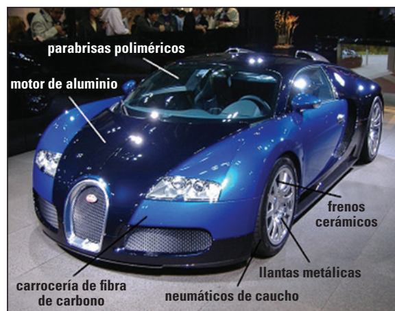
Figura 2.4. Auto moderno cuyas partes están construidas de diversos materiales, según las propiedades específicas que se requieran.
