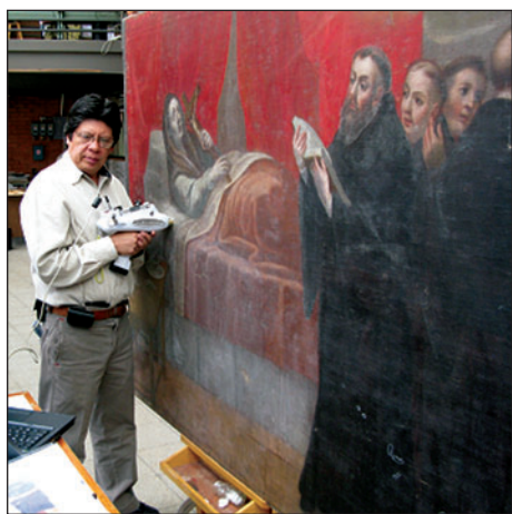
Figura 7.13. Análisis composicional de pinturas utilizando un equipo portátil de fluorescencia de Rayos X. Escuela Nacional de Conservación, Restauración y Museografía “Manuel del Castillo Negrete”, México.
