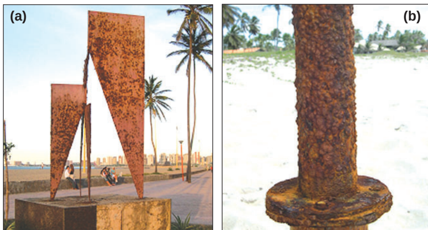
Figura 1.6. Degradación (corrosión atmosférica) de piezas metálicas expuestas a un ambiente marino. (a) Obra escultórica metálica; (b) Amarre costero. Fortaleza, Brasil.
