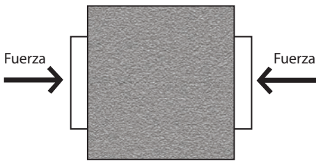
Figura 2.5. Material sometido a fuerzas de compresión donde se comparan su forma inicial (en blanco) con su forma final (en gris). Las flechas muestran la dirección y sentido de la aplicación de las fuerzas.
