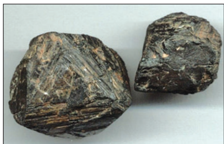
Figura 3.2. Mineral de hierro, óxido ferroso-diférrico o Magnetita Fe_3O_4
