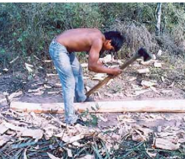
Trabajo de "escuadrado" de un poste realizado con el hacha por Sixto Lalecorí con destino al mercado local. San Lorenzo, Chaco, 2000.
