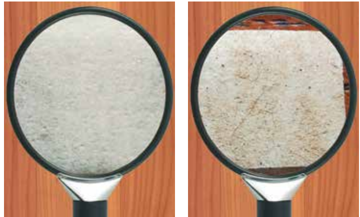
Imagen de cinta de papel (1 cm x 1 cm) tomada con la aplicación Magnifier, para Android. La primera imagen se tomó apenas colocado el sensor; la segunda, luego de algunos días de exposición.
