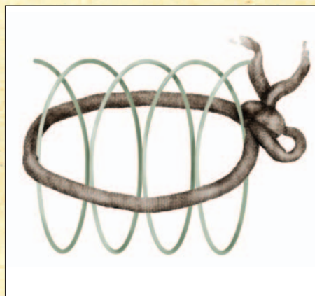
Una cuerda suficientemente fuerte hace que el resorte se mantenga comprimido.
