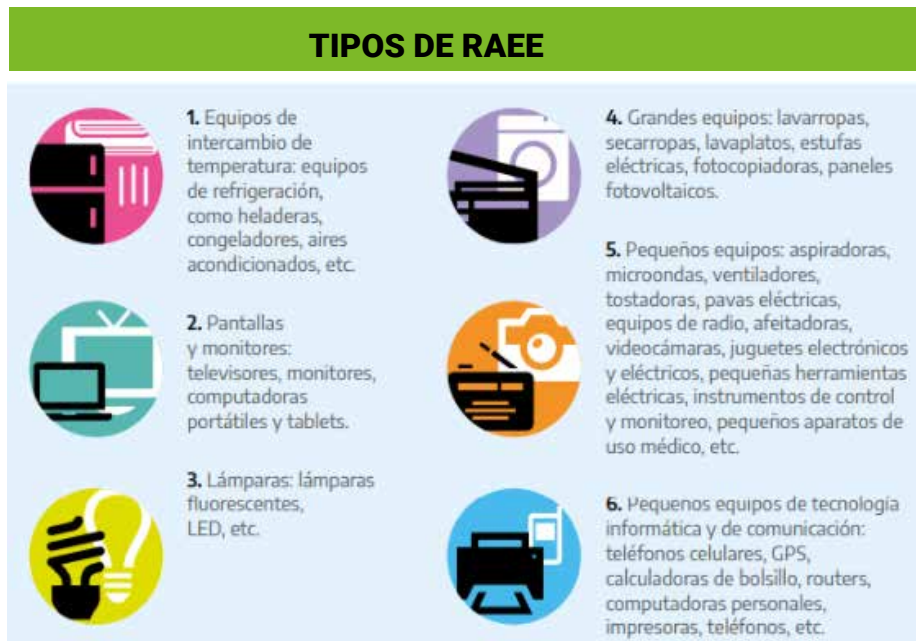
Figura 59: ejemplificación de los diferentes tipos de RAEEs y su clasificación. Fuente: Guía para la Implementación de la Gestión Integral de los Residuos Sólidos Urbanos. Anexo 24. Manual de Gestión Integral de RAEE_MAYDS.
