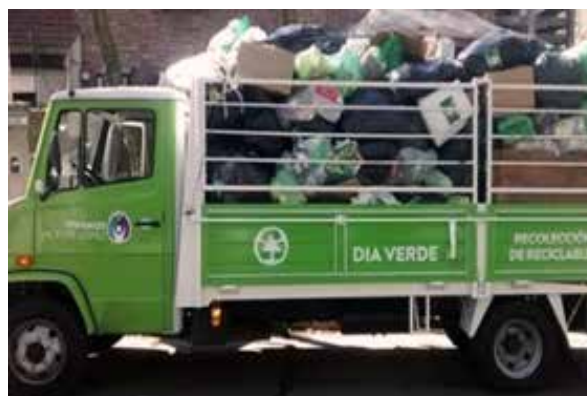
Figura 36: foto de medio de transporte denominado "camión de caja" o "jaula". Fuente: Guía para la Implementación de la Gestión Integral de los Residuos Sólidos Urbanos.
